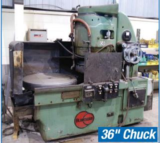
BLANCHARD ROTARY SURFACE GRINDER, MODEL NO18
